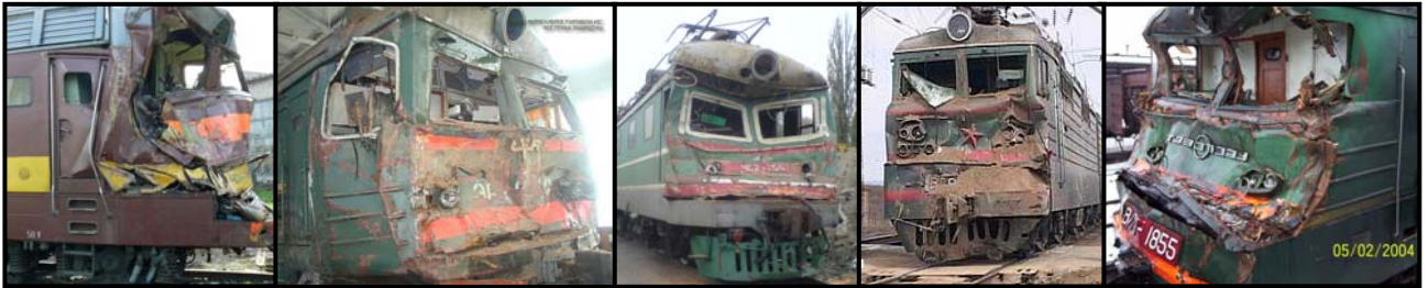
Рисунок 1.1 – Вид лобовой части кузова после аварийного столкновения
