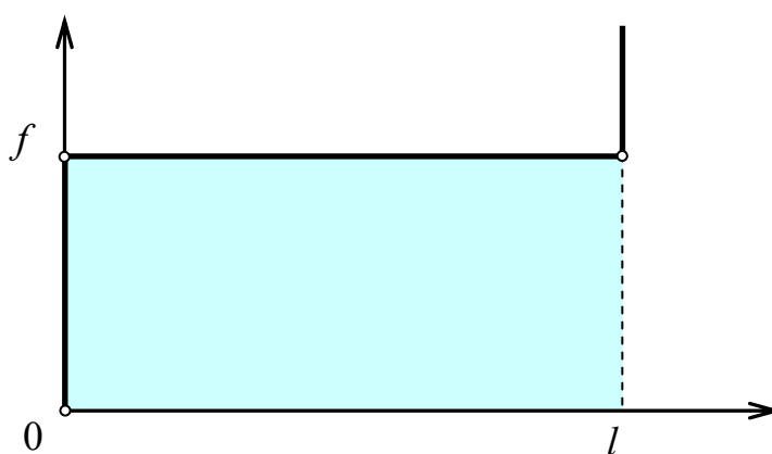
Рисунок 2.2 – Диаграмма жесткопластического деформирования устройства поглощения энергии
